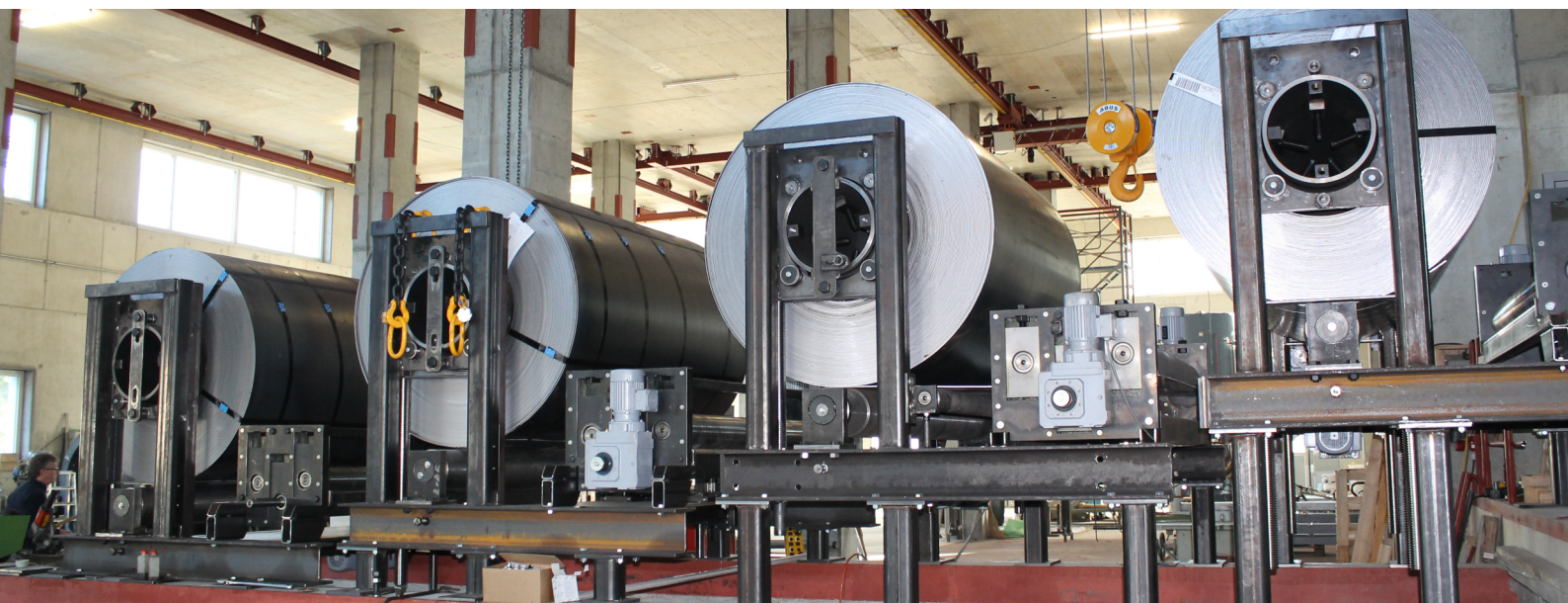
Fest installierte Maschinen für wirtschaftlichere Abläufe in der Grossspeicherproduktion; im Bild: Abcoilanlage
